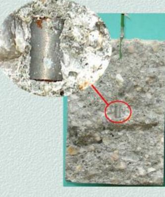
Spaltbildung trotz optimierter Herstellung bei allen zerteilten Beton- / Mörtelprobekörpern
