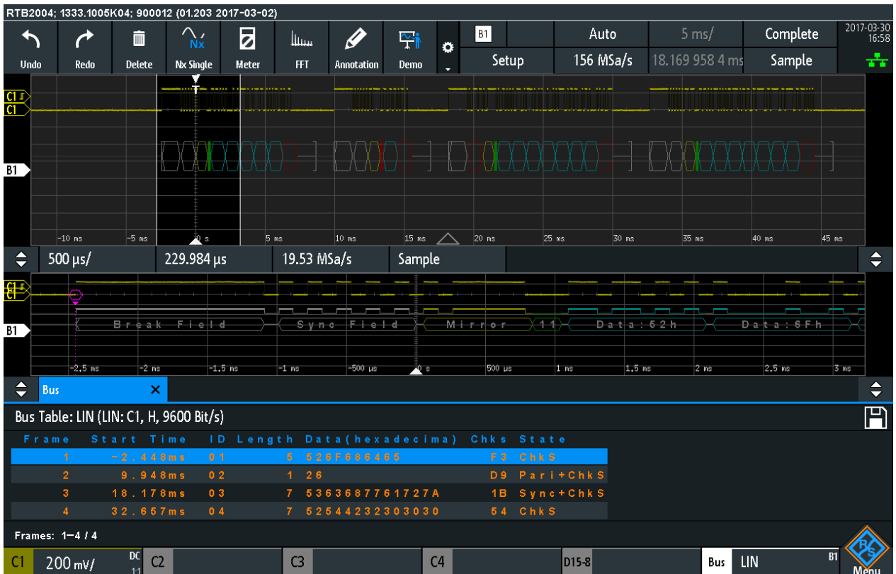
Bild 12-37: Decodiertes LIN-Signal mit Frametabelle und angewendeter Label-Liste
