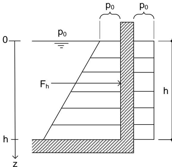
Bild 6: Horizontalkraft auf eine Behälterwand
