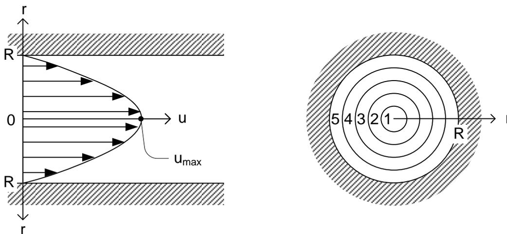
Bild 1: laminare Rohrströmung, links: Geschwindigkeitsprofil, rechts: Seitenansicht
