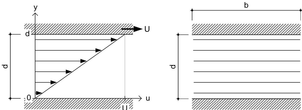
Bild 4: Scherströmung, links: Geschwindigkeitsprofil, rechts: Ansicht von rechts
