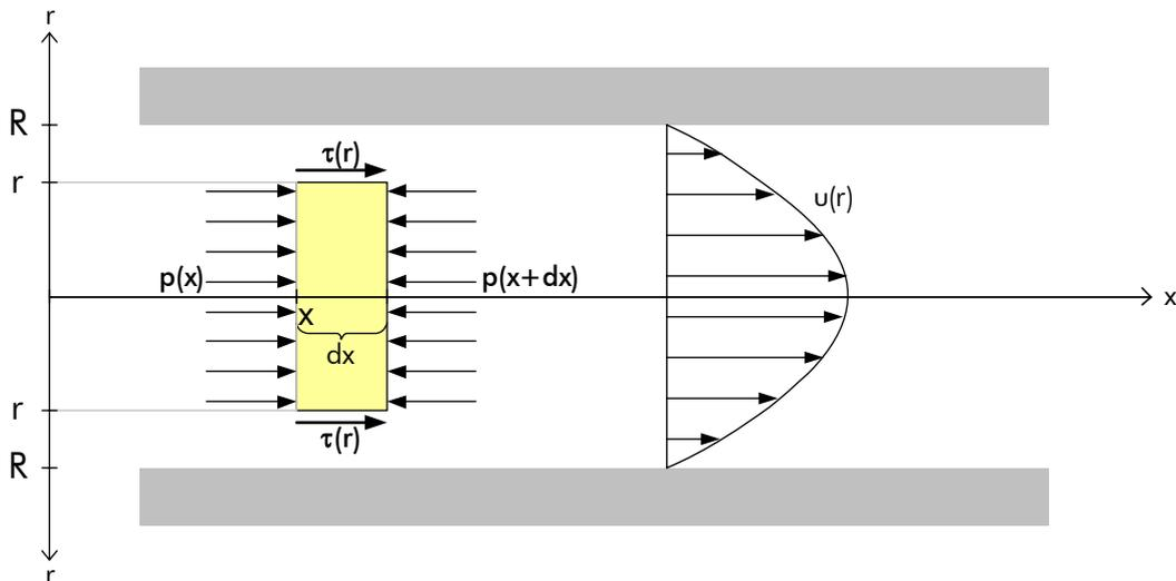
Bild 1: links Impulsbilanz, rechts Geschwindigkeitsprofil
