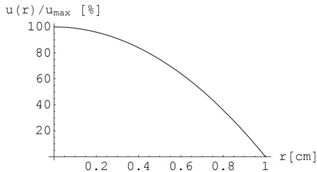
Das entspricht dem in Bild 1 rechts gezeigten Geschwindigkeitsprofil  $u(r)$ .
