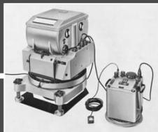
Reihenmeßkammer mit Überdeckungsregler, Nach: *S. Schneider, 1974*
