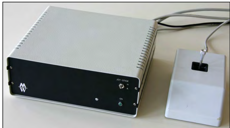
Bild 1 Kreuztisch (oben) und Schrittmotorsteuerung mit Joystick (unten)
