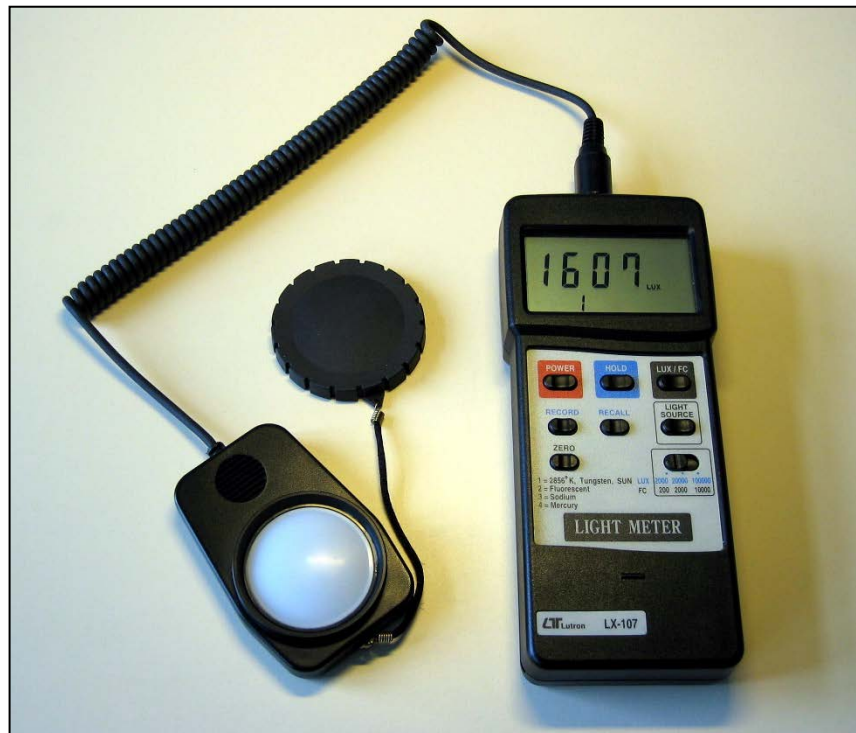
Bild 1 Messgerät und -kopf mit Lichtsensor (weiße Kuppel)
