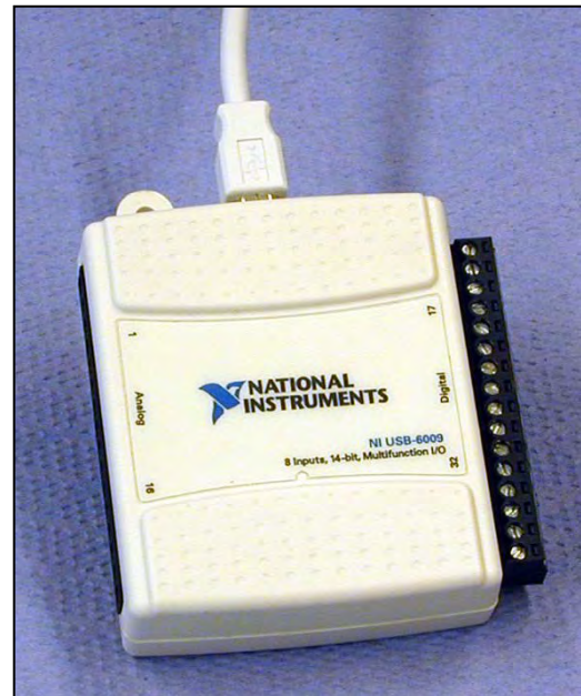
Bild 1 Multifunktions-Datenerfassungsmodul USB-6009 mit einer Schraubklemmenleiste
