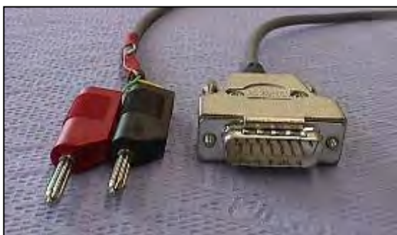
Bild 6 Anschlusskabel Volt DC
