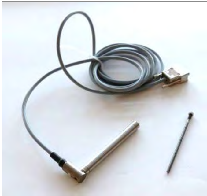
Bild 1 Induktiver Wegaufnehmer WA/50mm-L mit Tauchanker (rechts)
