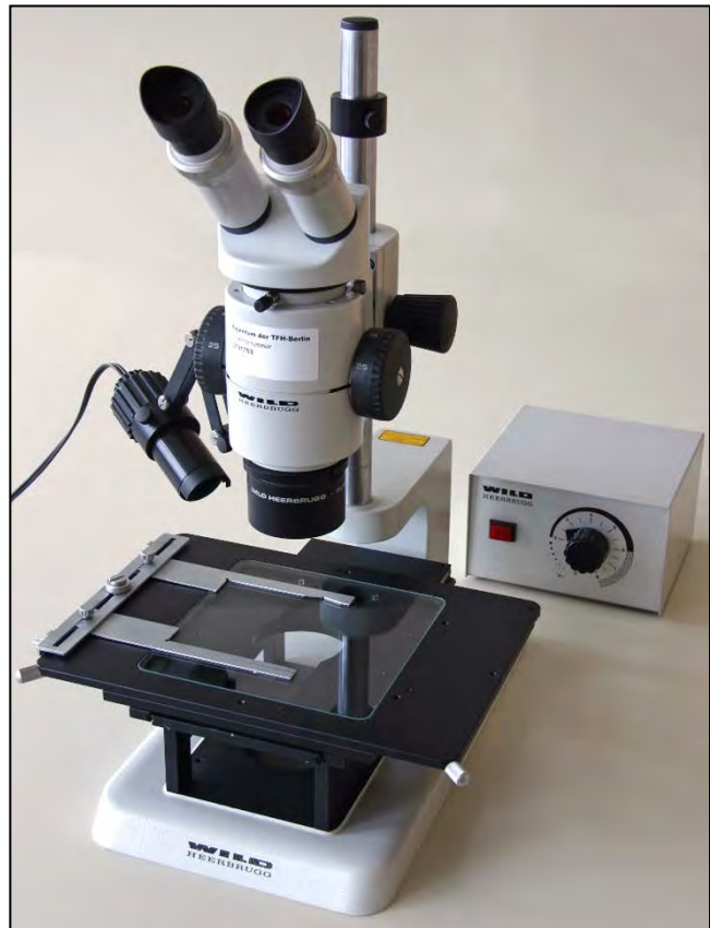
Bild 1 Zoom-Stereomikroskop mit Auflichtbeleuchtung (& -Netzteil) am Durchlichtstativ mit Objektstisch
