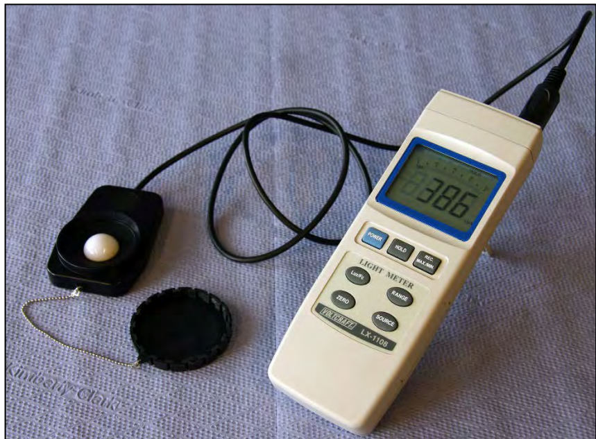
Bild 1 Messgerät und -kopf mit Lichtsensor (weiße Kuppel)
