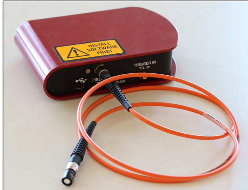
Bild 1 Spektrometer CCS 200/M mit Glasfaser und Kosinus-Korrekturvorsatz
