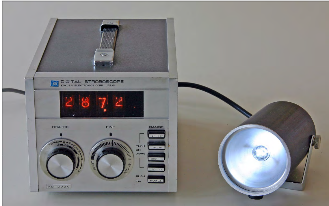
Bild 1 Zählereinheit und Blitzleuchte
