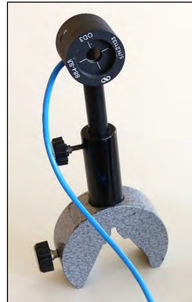
Bild 1 Si-Fotodetektor 818-SL/DB mit OD3-Filter auf M4-Gewinde-Stativstange in Reiter
