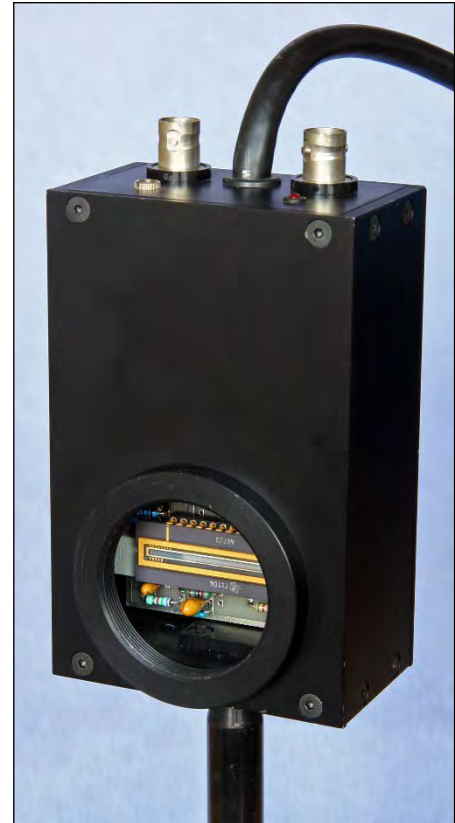
Bild 1 Kameragehäuse mit CCD-Zeile
