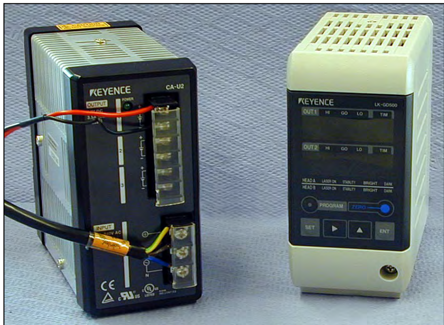
Bild 1 Steuergerät LK-G 3001P mit Spannungsversorgung (links)
