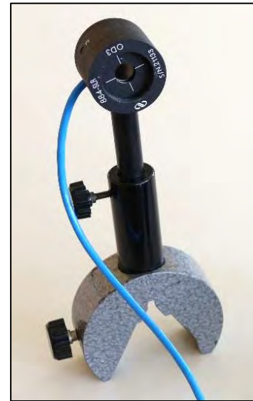
Bild 1 InGaAs-Detektor 818-IG/DB mit OD3-Filter
