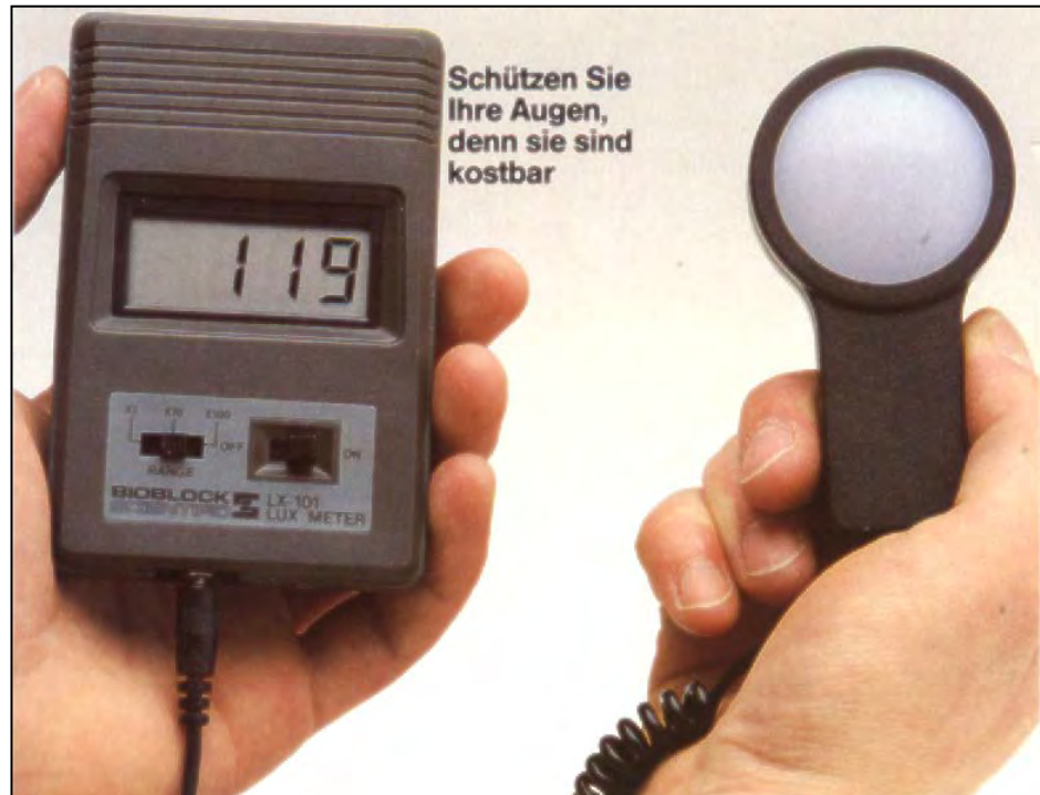
Bild 1 Messgerät und -kopf mit Lichtsensor (weiße Kuppel)
