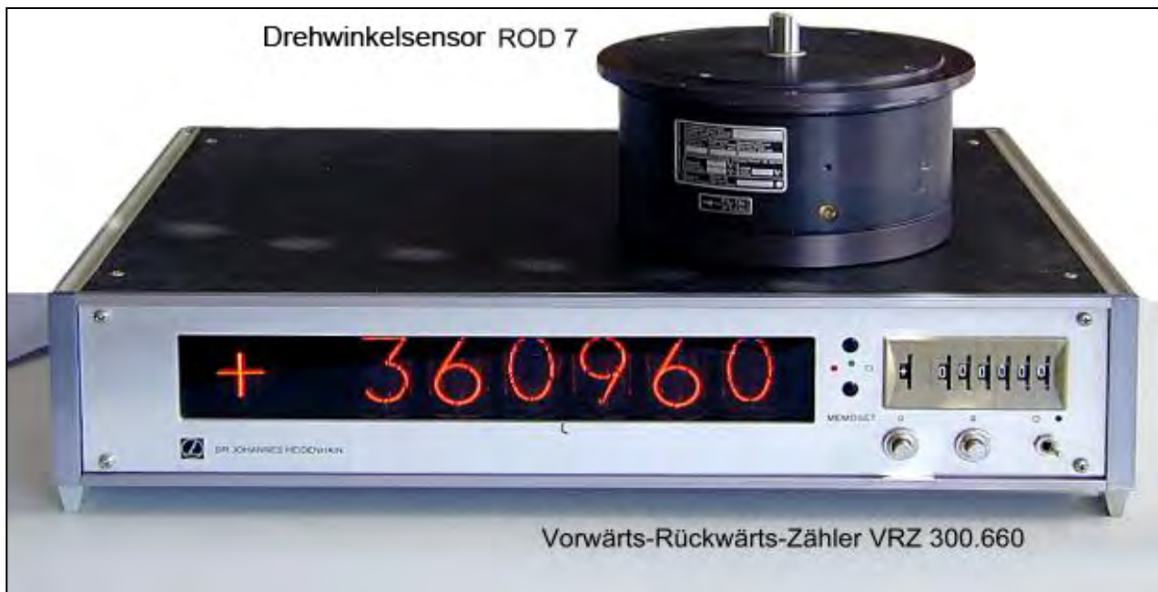
Bild 1 Drehwinkelsensor mit Vorwärts-Rückwärtszähler
