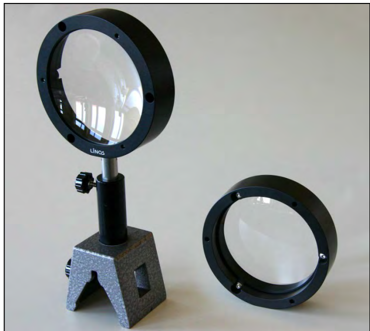
Bild 1 Plankonvexlinse gefasst, links mit Stativstange und Halter für optische Bank
