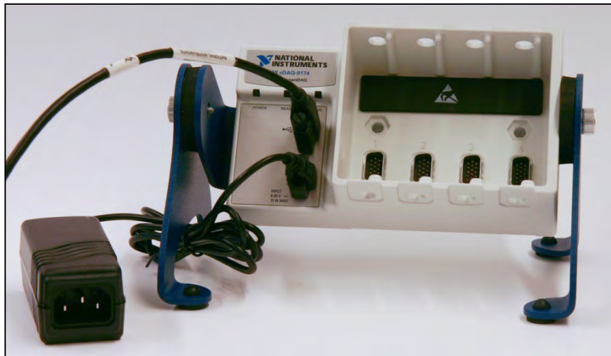
Bild 1 CompactDAQ-Chassis cDAQ-9174 mit 4 Steckplätzen, Netzteil und USB-Anschlusskabel
