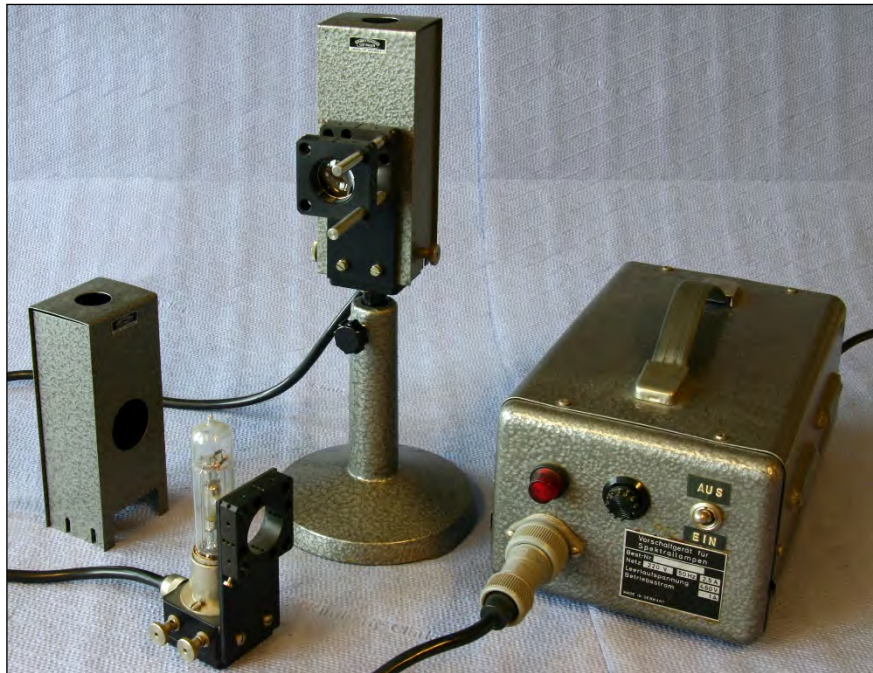
Bild 1 HgCd-Spektrallampe mit Vorschaltgerät, Cd-Lampe in Lampenfassung mit abgenommenem Lampengehäuse
