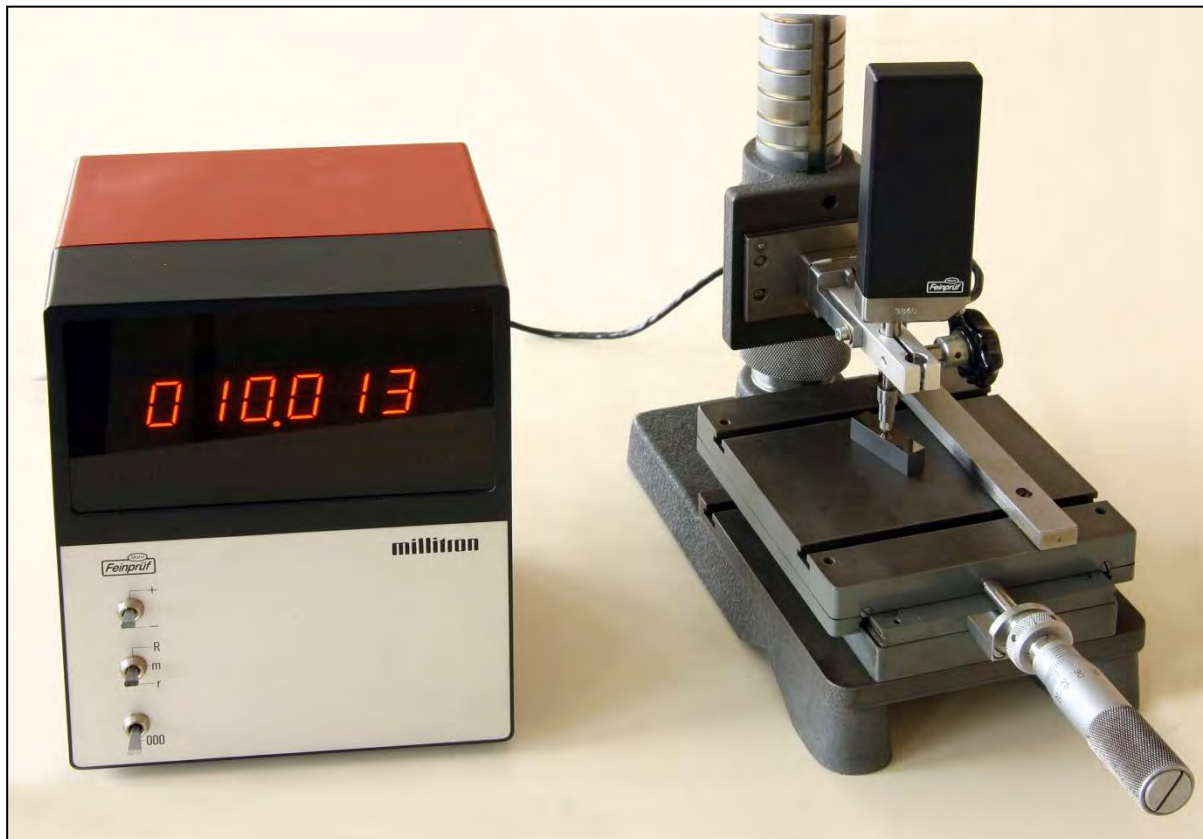
Bild 1 Messwertanzeige Millitron 1500, Messtaster 1530 mit Messstativ
