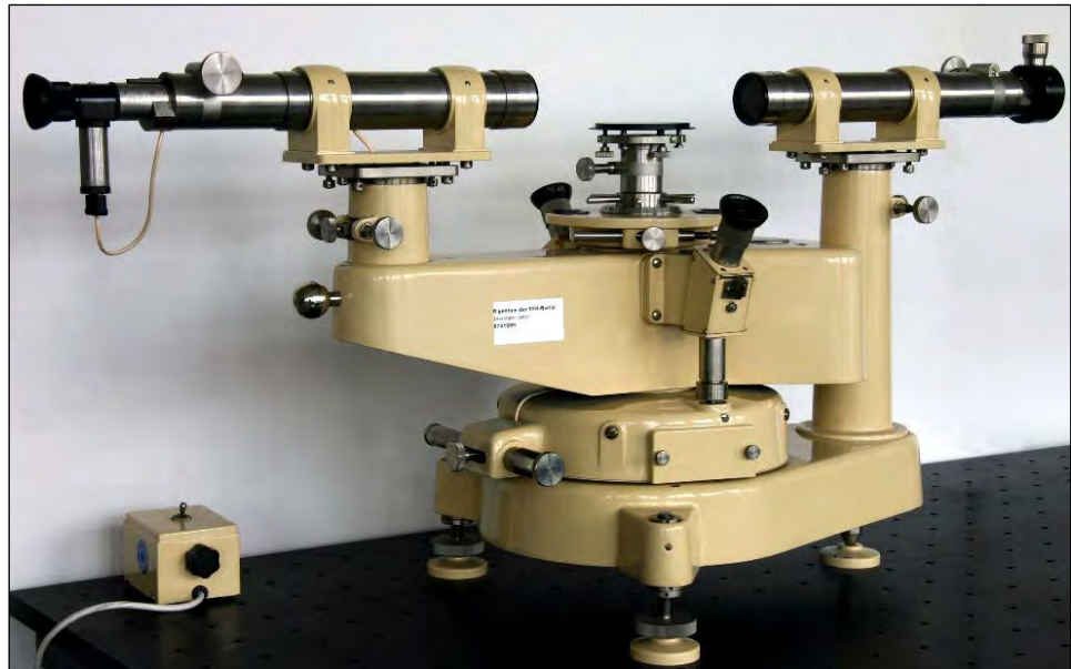
Bild 1 Präzisionsspektrometer mit Netzteil für Okularbeleuchtungen
