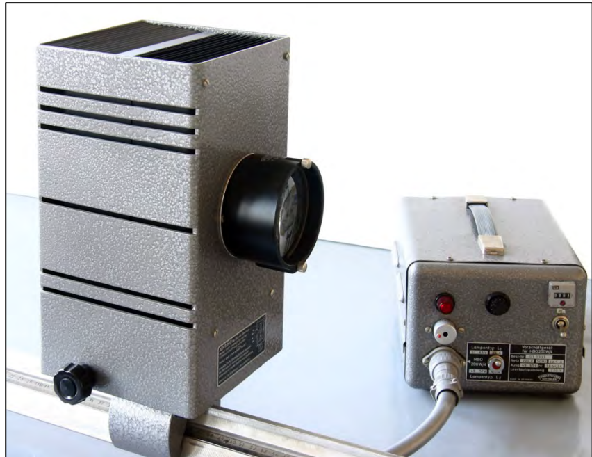
Bild 1 Lampengehäuse mit Kondensator und Vorschaltgerät
