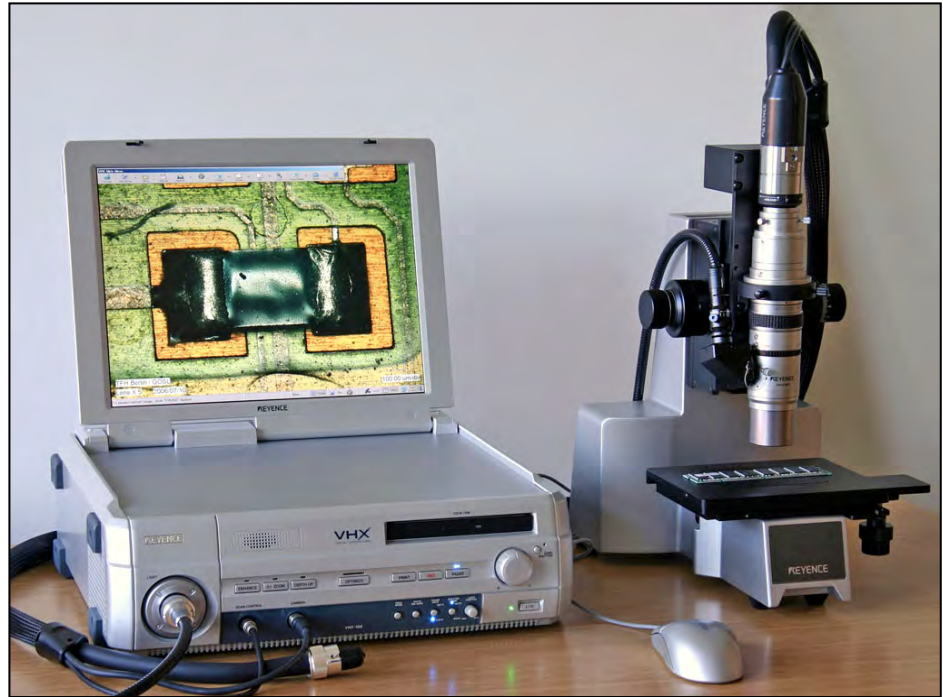
Bild 1 Zentrale Steuereinheit mit Flachbildschirm, Zoomobjektiv in Stativ gehalten
