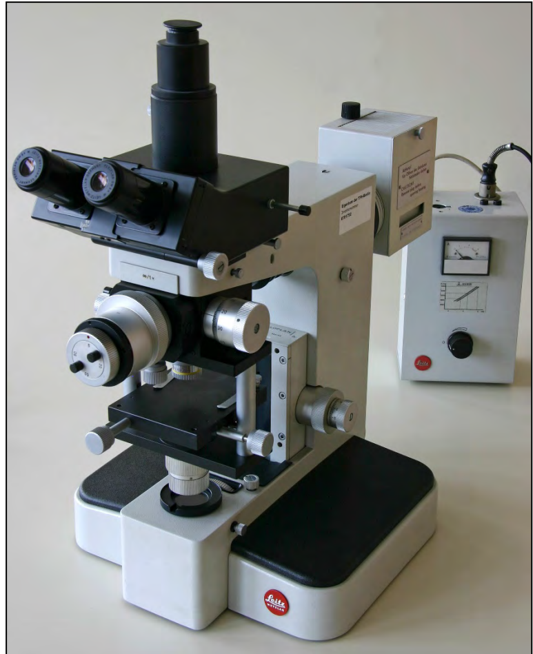
Bild 1 Großfeld-Mikroskop mit Auflicht-Interferometer-Erweiterung
