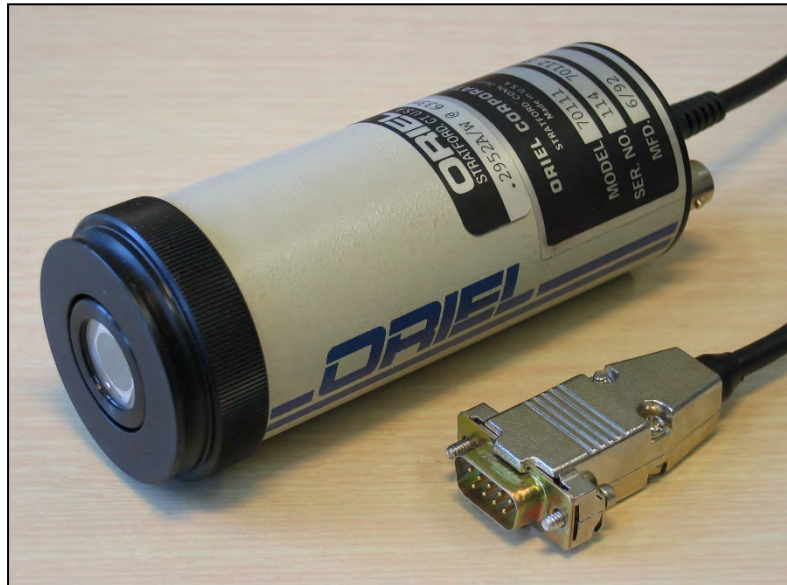
Bild 1 Si-Fotodetektor (-Gehäuse) mit Anschlussstecker für Merlin™
