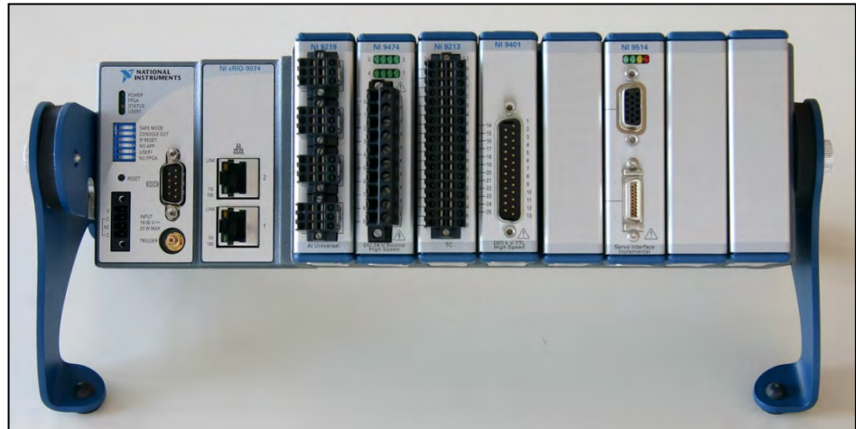
Bild 1 CompactRIO-Chassis NI cRIO-9074 mit 5 eingesteckten I/O-Modulen aus der C-Serie von National Instruments
