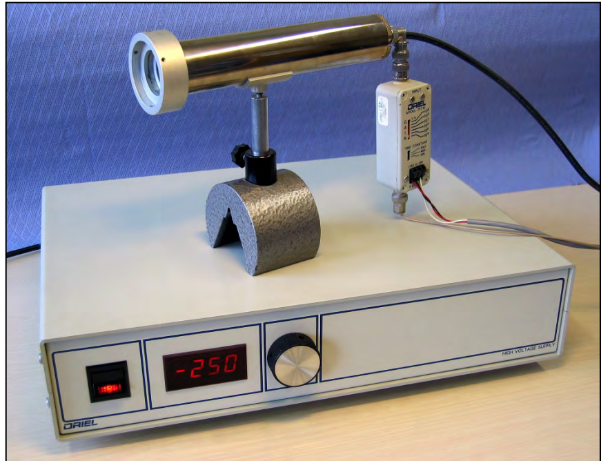
Bild 1 Fotomultiplier (-Röhre) mit Stromverstärker und Spannungsversorgung
