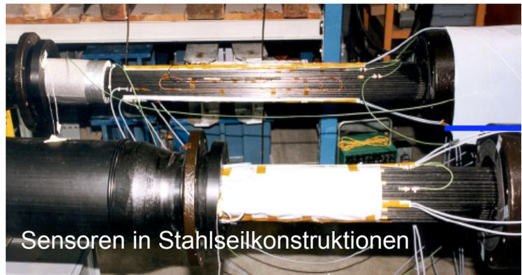
Sensoren in Stahlseilkonstruktionen
