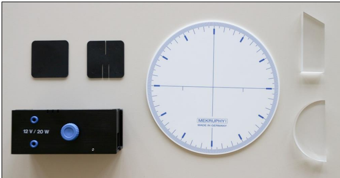
Abbildung 1 Komponenten für den Versuch (v.l.n.r.): Experimentierleuchte mit Verschlusscheibe und Schlitzblende, Winkelscheibe, Prisma/Platte und Halbzylinder
