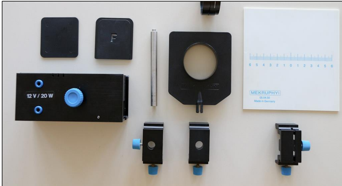
Abbildung 1 Komponenten für den Versuch (v.l.n.r.): Experimentierleuchte mit Verschlusscheibe und F-Blende, Stativstange, Reiter mit Schraube, Bildschirm mit mm-Skala, Reiter mit Schlitz
