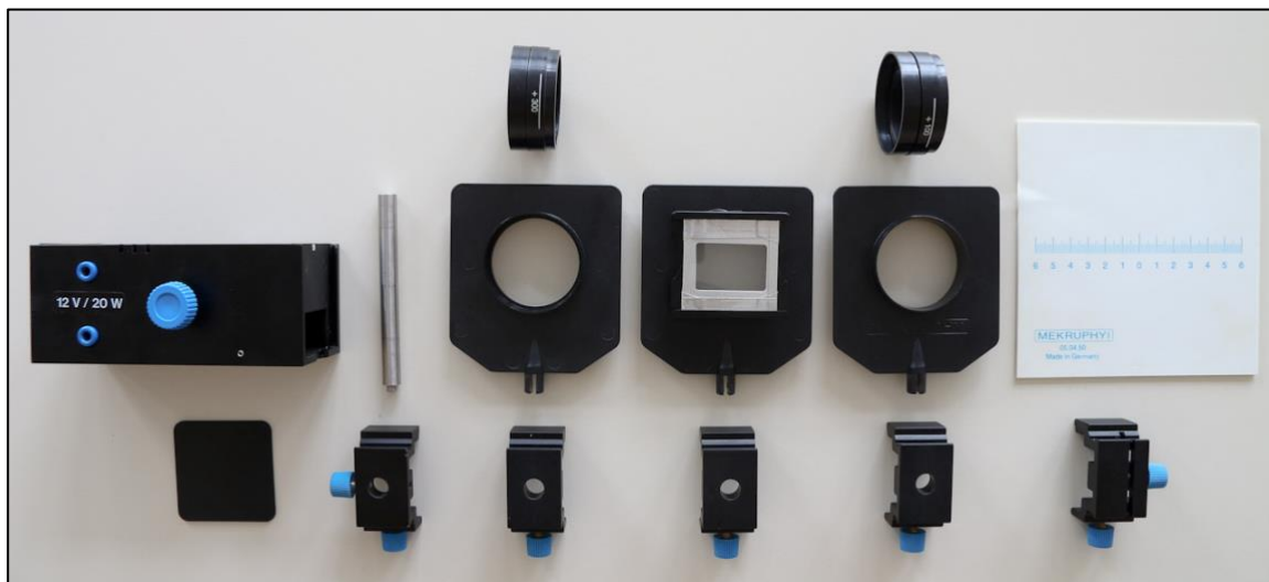
Abbildung 1 Komponenten für den Versuch (v.l.n.r.): Experimentierleuchte mit Vollblende, Stativstange und Reiter mit Schraube, Linse f' = 100 mm mit Linsenhalter und Reiter, Transmissionsgitter in Diahalter mit Reiter, Schirm mit mm-Skala und Reiter mit Schlitz
