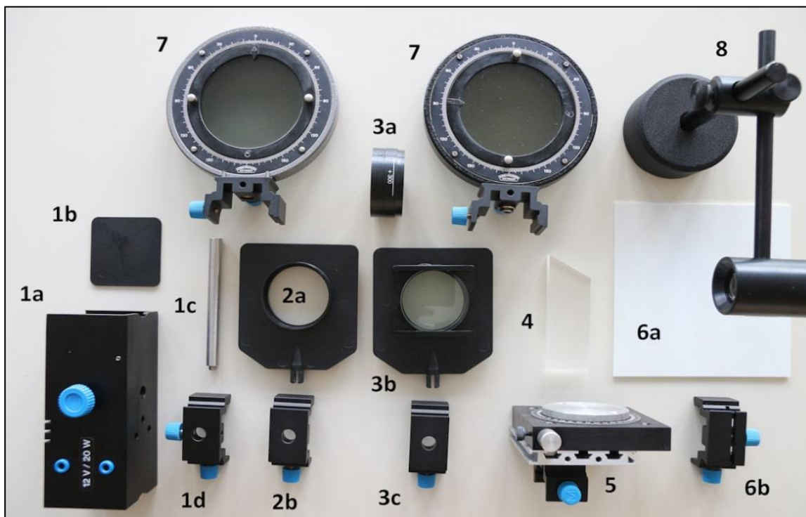
Abbildung 1 Komponenten für den Versuch: Experimentierleuchte (1a) mit Verschlussblende (1b), Stativstange (1c) und Reiter mit Schraube (1d), „Blende“ (2a) mit Reiter (2b), Linse in Fassung (3a) mit Linsenhalter + Infrarot-Sperrfilter (3b) und Reiter (3c), Drehtisch (5), Schirm (6a) und Reiter mit Schlitz (6b), 2 Linear-Polarisationsfilter (7), Detektorkopf des opt. Leistungsmessgerätes (8)
