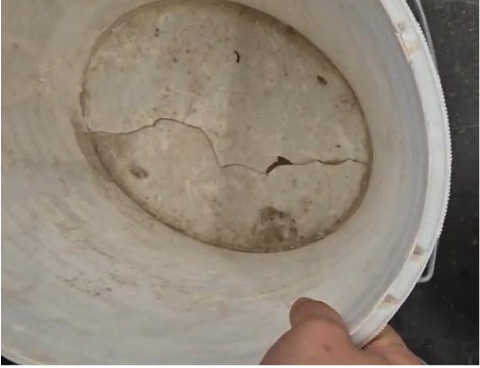
Abb. 5.3: Rissbildung im Bodenbereich eines gebrauchten Eimers
