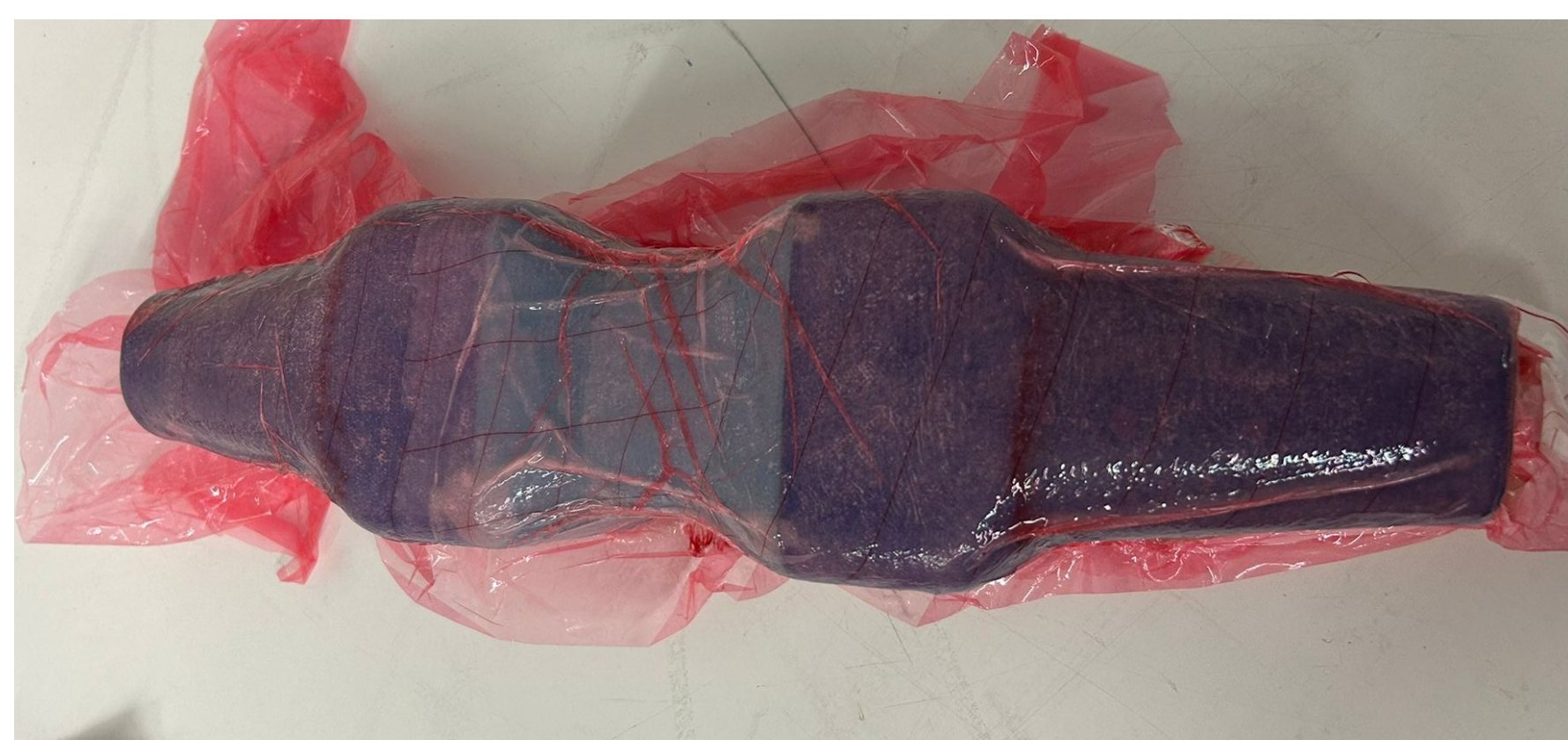
Abb 3: Vakuumaufbau für eine Antriebswellenverkleidung – die vielen engen Rundungen haben sich als ungünstig erwiesen
