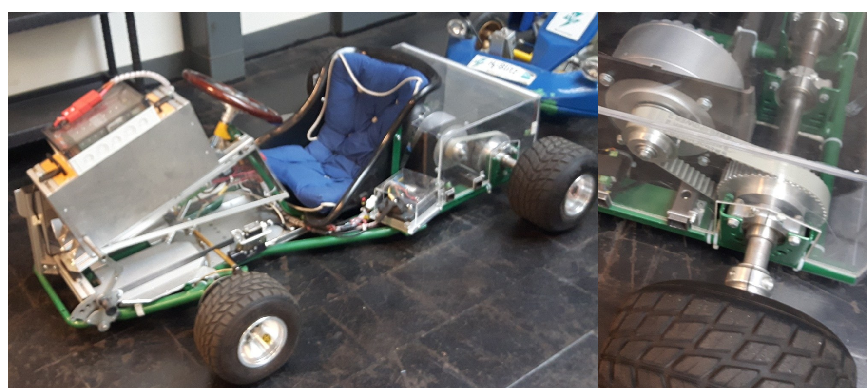
Abb 1: E-Kart des Labors für Elektrotechnik (links) und Antriebsstrang mit Motor, Zahnriementrieb und Antriebswelle (rechts)
