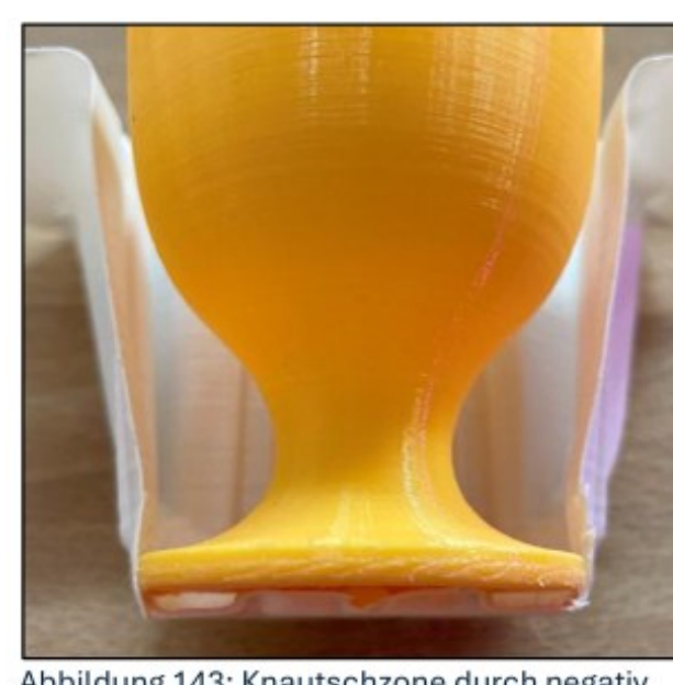
Abbildung 143: Knautschzone durch negativ geformtes Recyclinglogo
