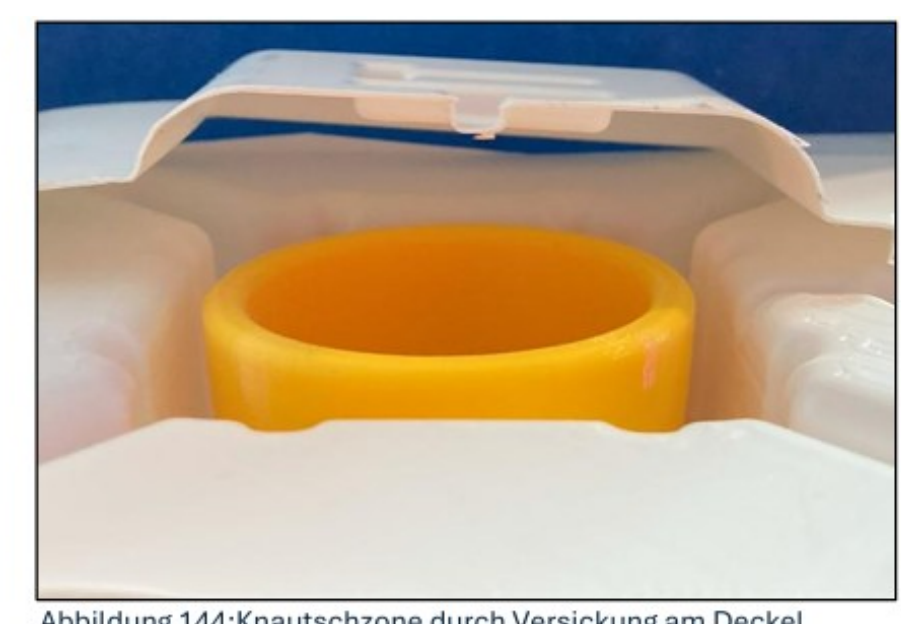
Abbildung 144: Knautschzone durch Versickung am Deckel
