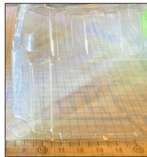
Abbildung 4: An Ecke designte Schräge zum Verhindern von Faltenbildung bei Weintraubenverpackung
