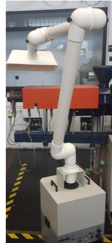
Mobiler Lüfter am Extruder
