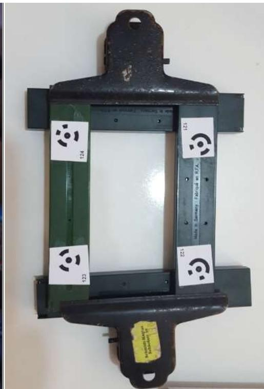
Abb. 20: Konstruktionsaufbau mit Passpunkten
