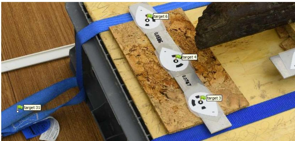
Abb. 46: Fehlerhaft gemessener Passpunkt auf dem Spanngurt
