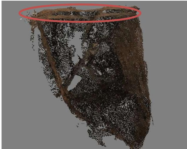
Abb. 54: Ausschnitt der dichten Punktwolke von 7986\_68\_6\_11 mit Doppelung durch Objektbewegung
