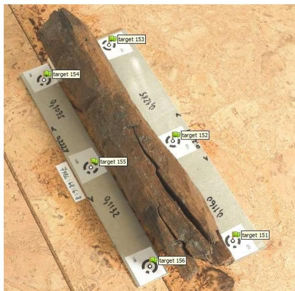
Abb. 31: Aufnahme eines Holzfragmentes mit erkannten Passpunktmarkern
