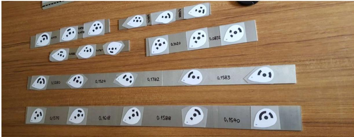
Abb. 22: Passpunktmaßstäbe mit aufgeklebten, laminierten Passpunktmarken
