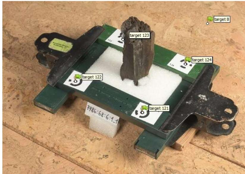
Abb. 32: Falsch erkannter Passpunkt auf der Korkunterlage
