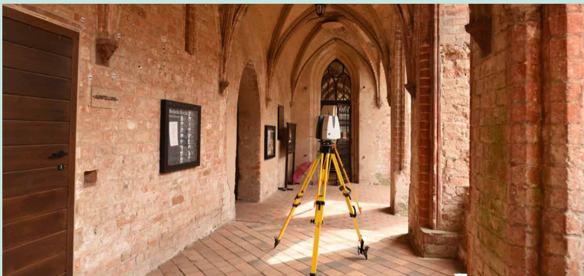
Durchführung terrestrischer Photogrammetrie und Laserscanning
