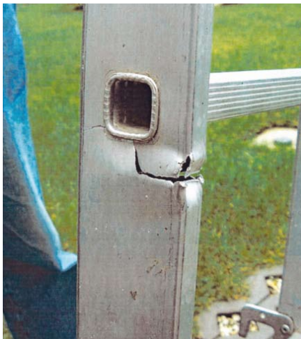
Bild 51: Stark beschädigte Leiter
