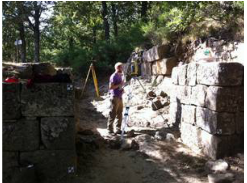
Passpunktmessung beim Haupttor am Monte Croccia - Foto: F. Bredemann
